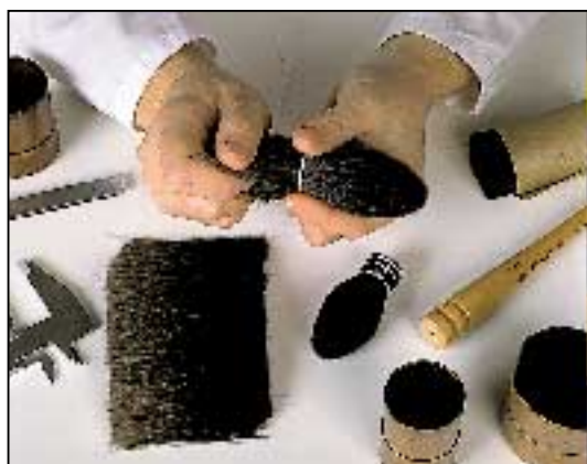
6. Mise en forme du bombé
