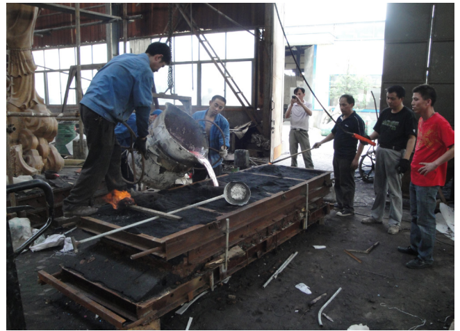
Coulage d'une côte. © LVAN.
