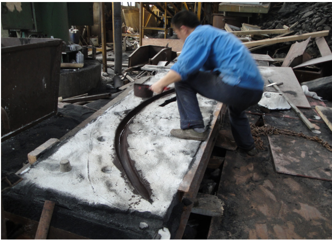
Coulage d'une côte. © LVAN.
