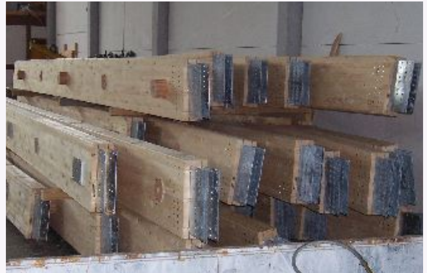
plaques de connexion installées
