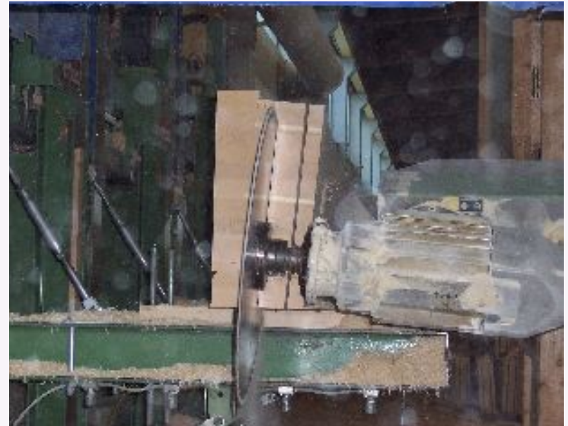
fraisage pour les plaques en acier des connexions longitudinales
