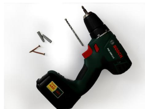
Pour percer votre mur, vous pouvez utiliser *a priori* une simple perceuse avec une mèche adaptée. Mais s'il est en béton ou en pierre, il vous faudra un appareil à percussion.
