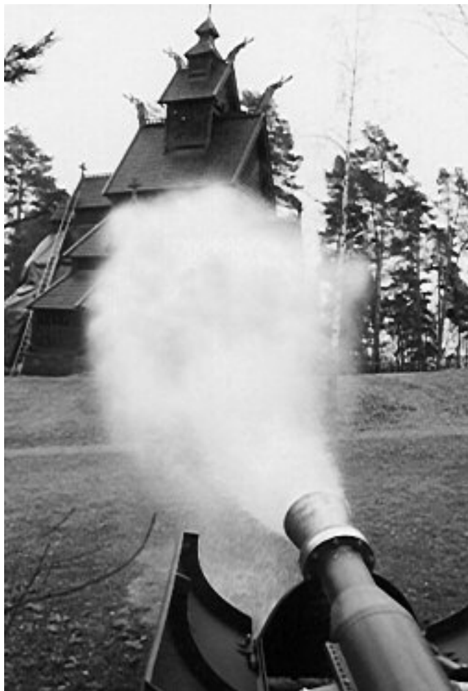
Essai d'un canon à eau unique (extincteur incendie à eau pulvérisée) Photo de l'auteur
