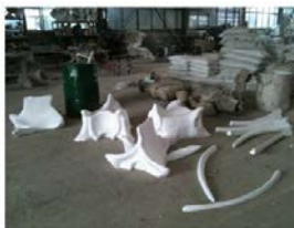
Prototype à échelle 1 en polystyrène d'après modélisation 3D
