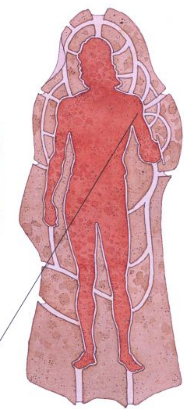
7. Le moule pour la fonte En faisant attention à ne pas boucher les ouvertures, on recouvre la statue et les canaux d'une couche de plâtre, de sable et de bouse de vache.
