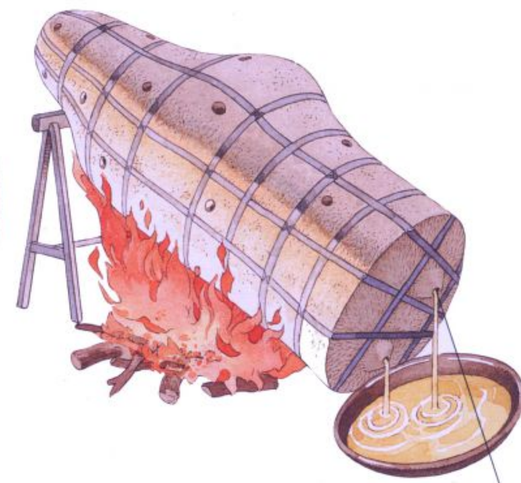
8. L'élimination de la cire On chauffe le moule de plâtre à 200-300 °C pour faire fondre la cire, qui libère ainsi un espace entre la statue de terre et le moule.
