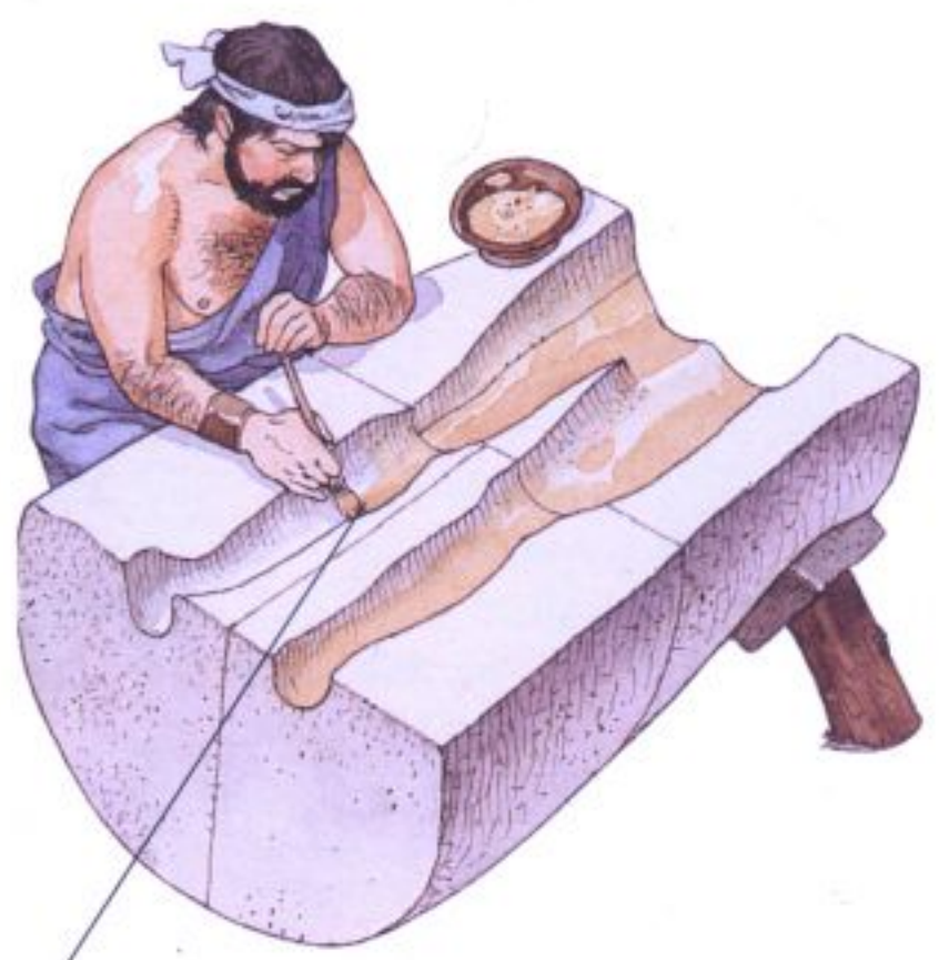
3. La cire Après avoir ouvert le moule, on enlève le modèle d'argile et les parois du moule sont recouvertes d'une fine couche de cire.
