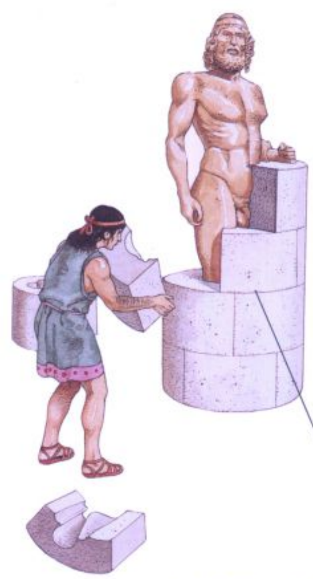
5. Le modèle en cire Quand la terre est sèche, on retire du plâtre la statue en terre couverte de cire.
